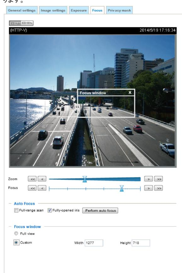
Exécutez la fonction Mise au point automatique pour optimiser l'image. Toutefois, si vous avez des caméras montées en cascade, faites-le une par une. N'effectuez pas cette fonction simultanément sur plusieurs caméras car l'objectif motorisé consomme également énormément d'énergie et peut entraîner l'interruption de la dernière caméra sur la ligne.
