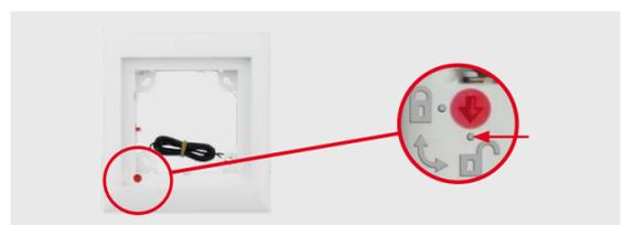
**Attention :** Lors des installations pour lesquelles aucun système antivol n'est nécessaire, un montage intérieur p. ex., n'activez **pas** le verrouillage antivol (le bouton rouge reste tourné vers le symbole « Serrure ouverte »). Si le bouton est malencontreusement tourné, il est nécessaire de s'assurer que le dispositif du système antivol peut être raccordé à une batterie (9 V CC) ! Si ce n'est pas le cas, le module ne pourra plus être desserré du cadre.
