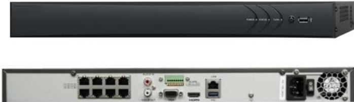
Der Roline RNR0208P ist ein 8 Kanal Netzwerk-Video-Recorder im 19 Zoll (1HE) Gehäuse und ist somit für Rack- und Tischinstallationen geeignet. Der RNR0208P verfügt über einen integrierten 8 Port PoE Switch und kann damit die Kameras direkt mit Strom versorgen. Zur lokalen Display-Anzeige kann ein HDMI oder VGA Bildschirm angeschlossen werden, die komplette Bedienung und Konfiguration kann dann per Maus vorgenommen. Auf diese Weise ist kein zusätzlicher PC für die Videowiedergabe erforderlich.
