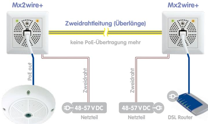
Falls die Spannung aufgrund einer Überlänge der Zweidrahtleitung für eine PoE-Versorgung der Mx2wire+ Gegenstelle nicht mehr ausreicht, können beide Mx2wire+ Einheiten aus einem Netzteil (48 – 57 V DC, 600 mA) versorgt werden.
