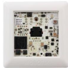
8. **Blende einsetzen:** Die Frontblende wird erst unten wie im Bild gezeigt eingehängt und dann aufgedrückt.
