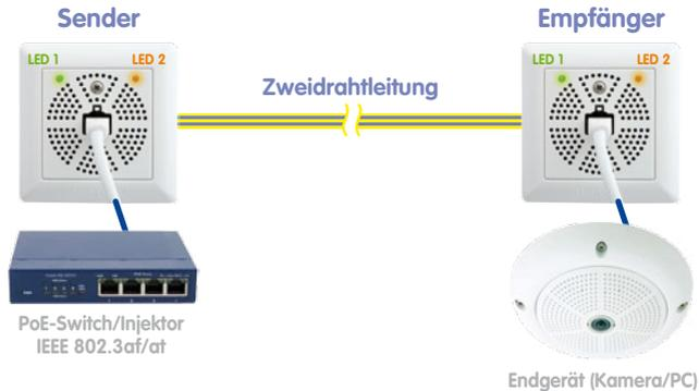
Als Sender wird die Mx2wire+ Einheit bezeichnet, die vom Switch mit Strom versorgt wird, da die Daten in beide Richtungen übertragen werden
