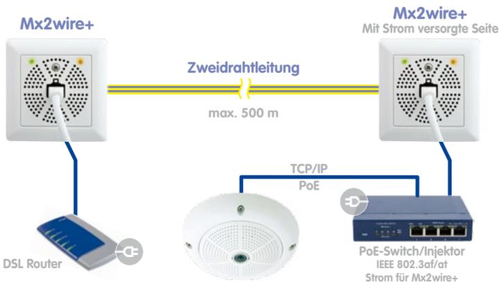
Ein Anschluss des DSL-Routers ohne PoE-Versorgung ist nur möglich, wenn eine PoE-Einspeisung an der anderen Mx2wire+ Einheit erfolgt.
