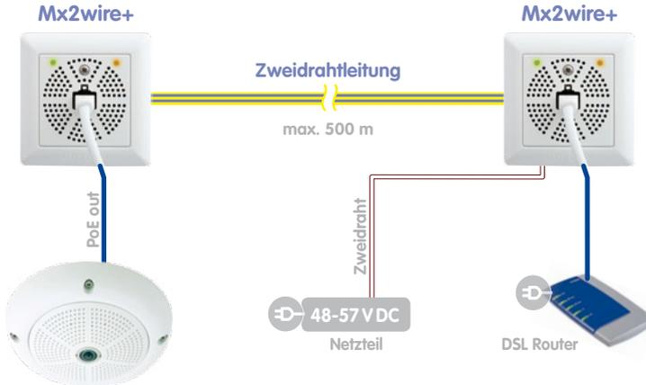
Die für Mx2wire+ und ein PoE-Endgerät notwendige Energie kann auch per Anschluss eines externen Netzteils (48 – 57 V DC, 600 mA) an einer beliebigen Mx2wire+ Einheit eingespeist werden (max. Ausgangsleistung für Endgerät: PoE-Klasse 3 bzw. 13 W). Um unnötige Leistungsverluste zu reduzieren, kann die externe Spannung alternativ an der Einheit mit dem angeschlossenen PoE-Endgerät angelegt werden.
