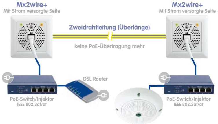
Falls die Zweidrahtleitung aufgrund ihrer Länge für eine PoE-Versorgung der Mx2wire+ Gegenstelle nicht ausreicht, können beide Seiten mit Strom via PoE versorgt werden.
