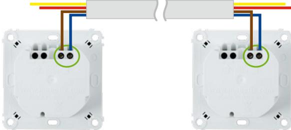
Vor der Montage der beiden Mx2wire+ Einheiten sollte die einwandfreie Funktion der Kabelverbindung sichergestellt sein (evtl. Messprotokoll anfertigen). Für weitere Entfernungen eignen sich Koaxkabel und Ethernetkabel (Cat-7) bauartbedingt am besten.
