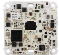
5. **Gehäuse mit Platine in Dose einsetzen:** Die beiden Kabelklemmen an der Rückseite des Gehäuses befinden sich oben. Verwenden Sie bei der Hohlraumdose (Pos. 1.9) nur die mitgelieferten Edelstahlschrauben (Pos. 1.6). Andere (größere) Schrauben könnten die Platine beschädigen.
