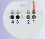
5. **Netzteilausgänge an Schraubklemme 3 und 4:** Verwendet man zur Spannungseinspeisung statt PoE-Switch/Injektor ein DC-Netzteil (48 – 57 Volt), erfolgt dessen Anschluss an einer beliebigen der beiden Mx2wire+ Einheiten. Siehe hierzu die Beschreibung der Anschlussalternativen in Abschnitt 3.2.
