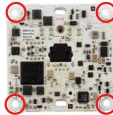
7. **Rahmen aufsetzen:** Gewünschten Rahmen (Pos. 1.3, konkav, konvex oder plan) mit leichtem Druck auf die Platine aufsetzen bis er automatisch einrastet. Der MOBOTIX-Schriftzug am Rahmen befindet sich unten.
