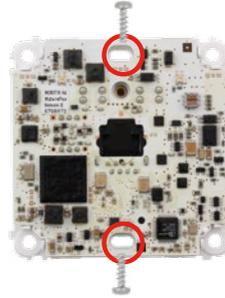
Befestigung der Platine mit zwei Schrauben (Pos. 1.4.) direkt an der Dose (siehe links) oder alternativ mit den Torx-Schrauben an der Wand (siehe Seite 22)
