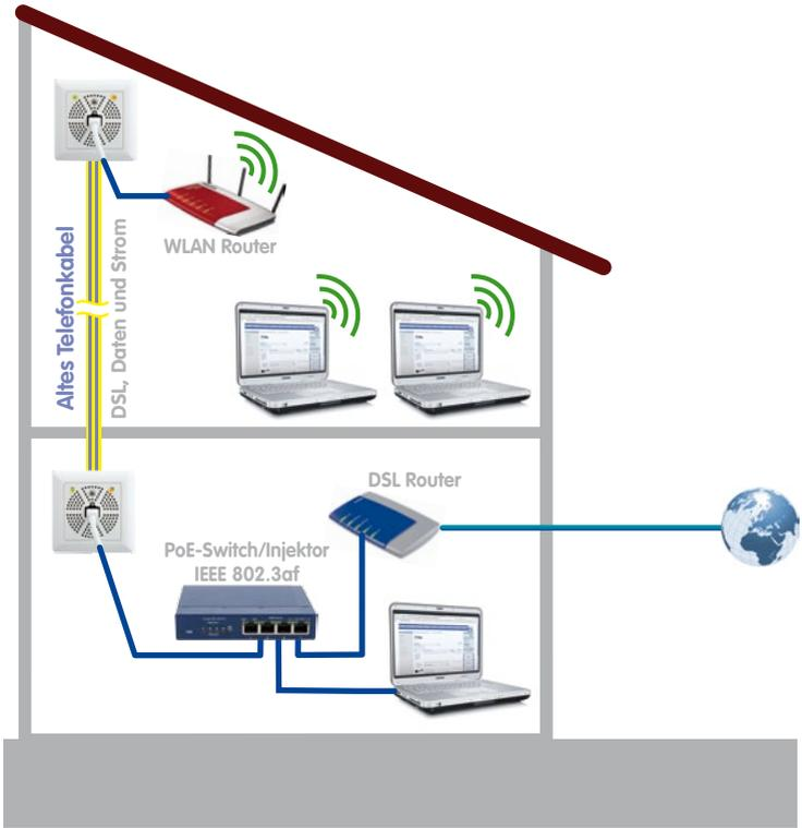
Stromversorgung des WLAN-Routers durch die Mx2wire+ Geräte (max. 13 W)
