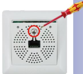
2. Stellen Sie mit Hilfe eines kleinen Schraubendrehers den Drehregler der an den Injektor/Switch angeschlossenen Mx2wire+ Einheit von Position 3 auf Position 4 (siehe Abbildung). Diese entsprechen den PoE-Klassen 3 und 4 des verwendeten Injektors/Switches.
