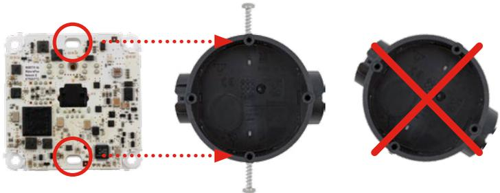
2. Das **Mx2wire+** Gehäuse mit Platine wird mit vier oder zwei (diagonal gegenüberliegenden) Torxschrauben/Dübeln (Pos. 1.6) **an der Wand festgeschraubt**. Diese Vorgehensweise empfiehlt sich, wenn die Unterputzdose nicht sauber ausgerichtet eingebaut ist, nicht bündig mit der Wand abschließt oder die Mx2wire+ Einheit sich sonst einfach mit der Unterputzdose herausziehen lassen würde.
