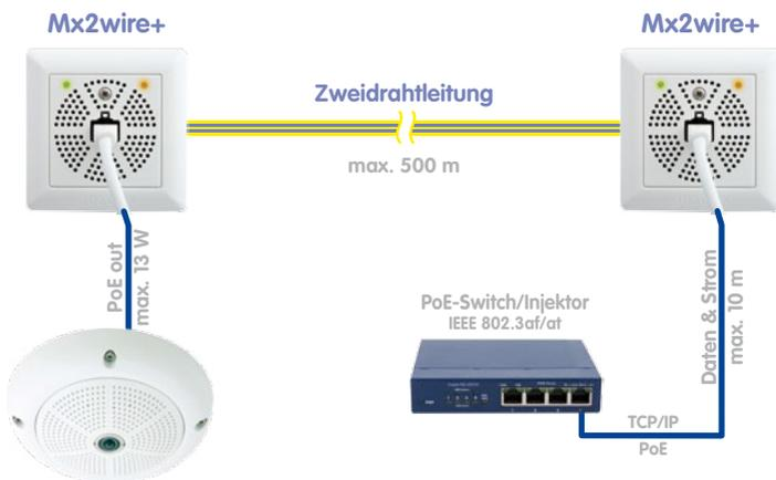
Der besondere Zusatznutzen von Mx2wire+ besteht darin, dass neben den Daten auch noch die Energie zum Betrieb von PoE-Endgeräten (Power over Ethernet nach dem Standard IEEE 802.3af, z. B. eine MOBOTIX Netzwerk-Kamera) über die verwendete Zweidrahtleitung übertragen werden kann.
