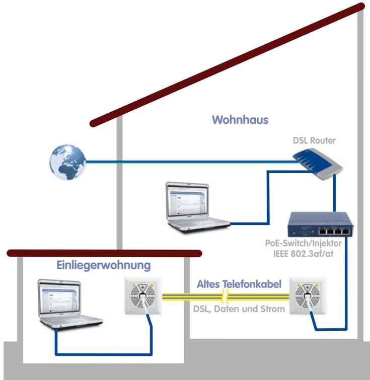
c) Anbindung WLAN-Router an entlegenen DSL-Anschluss
