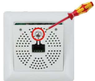
Heben Sie nun noch den aufgesteckten Rahmen von der Platine ab. Bitte beachten Sie, dass auch die Edelstahlschraube der Frontblende später wieder benötigt wird.
