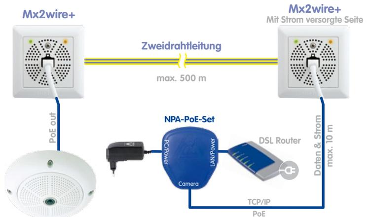
Alternativ zu einem Standard-PoE-Switch (IEEE 802.3af) kann das bei MOBOTIX als Zubehör erhältliche, blaue NPA-PoE-Set (MX-NPA-PoE-Set) verwendet werden.
