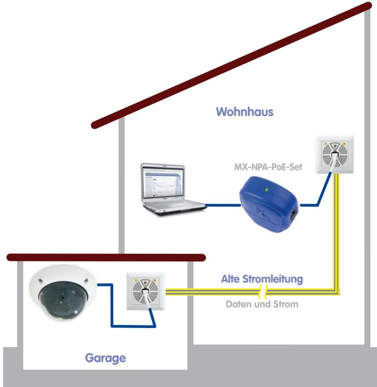
Ein ehemals als Stromanschluss genutzter Zweidraht dient hier zum kostengünstigen Anschluss einer IP-Kamera in der Garage
