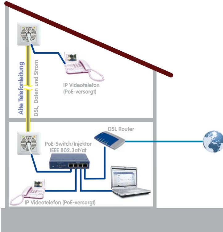
Kein Stromanschluss für Mx2wire+ Gerät und IP-Telefon notwendig, wenn dieses per PoE bis 13 W gespeist werden kann
