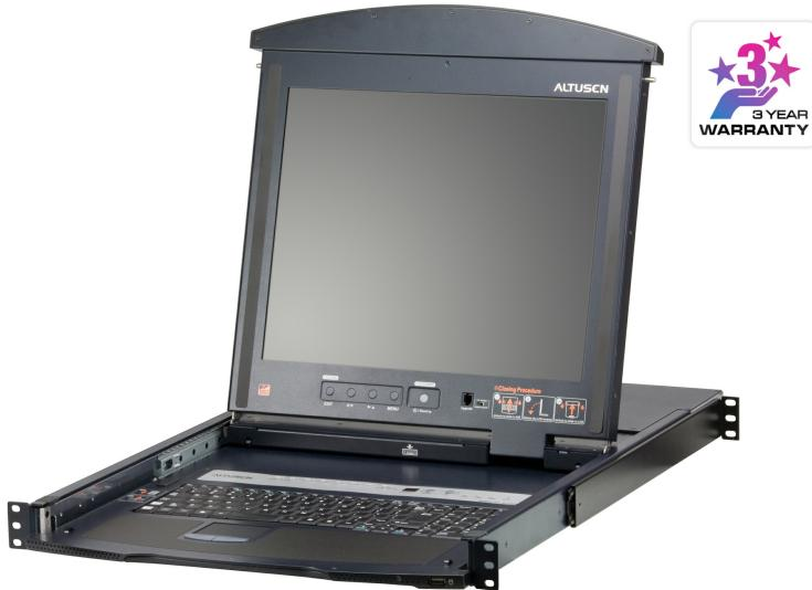
Le commutateur KVM à écran LCD KL1508A ATEN présente un écran LCD de 17" ou 19" LCD à double rail escamotable et un clavier avec pavé tactile intégré indépendants. Les commutateurs KVM KL1508A sont des unités de commande qui permettent aux administrateurs informatiques d'accéder à plusieurs ordinateurs et de les commander à partir de la console LCD et d'une console KVM PS/2 ou USB supplémentaire.
