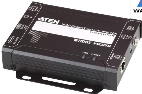
Le VE1812T comporte la fonction d'alimentation sur HDBaseT (PoH) qui envoie l'alimentation de Tx à Rx sur le câble Cat 5e/6/6a sans alimentation supplémentaire. Le VE1812T prend en charge la transmission de signal RS-232 et IR, vous permettant de contrôler l'appareil source HDMI depuis le récepteur ([VE1812R](#)) tout en accédant au périphérique d'affichage HDMI de l'émetteur (VE1812T). Les signaux infrarouges peuvent également être étendus dans les deux sens.
