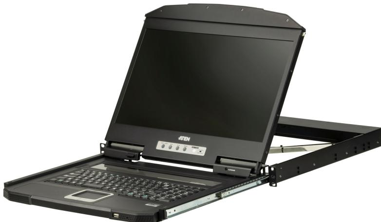
La console LCD VGA USB CL3100 est une console KVM LCD à rail unique de courte profondeur dotée d'un moniteur LCD rétroéclairé par DÉL de 18,5" avec clavier et pavé tactile intégrés. La conception à courte profondeur s'adapte à toutes les armoires d'équipement 19" et convient particulièrement aux racks peu profonds. La CL3100 offre une solution peu encombrante pour les environnements spéciaux, comme les fourgonnettes de diffusion extérieures (cars régies) et les salles de contrôle compactes.
