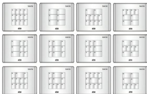
Le placement personnalisé des boutons sur le Bloc de commande peut être configuré en 125 combinaisons différentes de 6 à 12 boutons. L'exemple ci-dessus montre les 12 plus utilisées.
