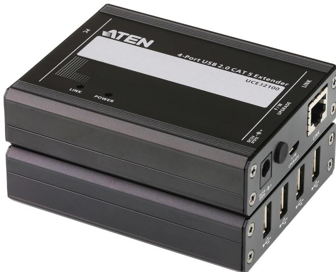
L'UCE32100 est un Extensions USB 2.0 CAT 5 à 4 ports et un appareil à deux unités qui sert d'unité locale (Tx) et d'unité distante (Rx). Il fournit une connexion durable et de haute qualité qui exploite toutes les capacités de la norme USB 2.0, pour assurer une communication de données fiable.
