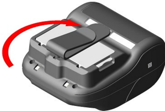
Abbildung 15-4 Anbringung des Gürtelclips (4)
