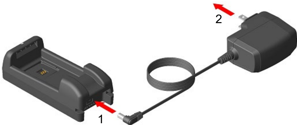
Abbildung 19-2 Verbinden des Akkuladegeräts mit dem Netzteil
