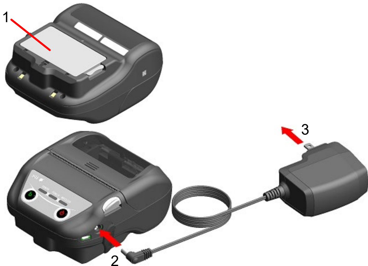
Abbildung 16-2 Aufladen im ausgeschalteten Lademodus mit dem Netzteil
