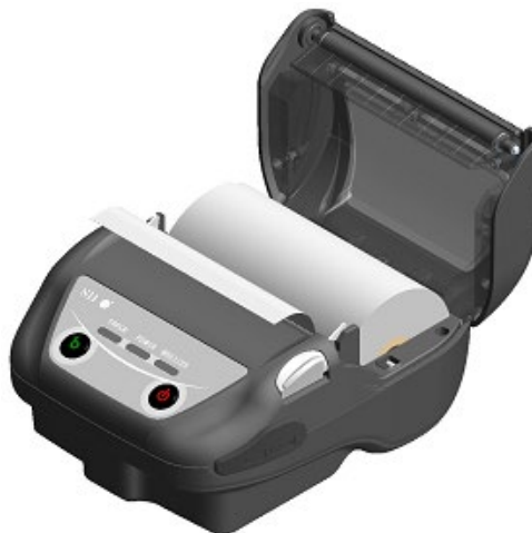
Abbildung 9-3 Einsetzen des Thermopapiers
