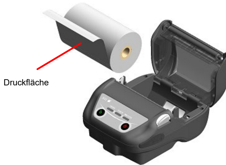
Abbildung 9-2 Ausrichtung des Thermopapiers beim Einsetzen
