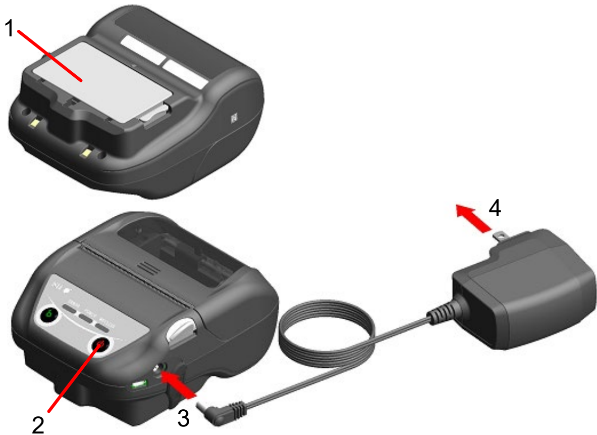
Abbildung 16-1 Aufladen im eingeschalteten Lademodus mit dem Netzteil
