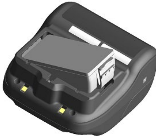
Abbildung 8-2 Einlegen des Akkupakets (1)
