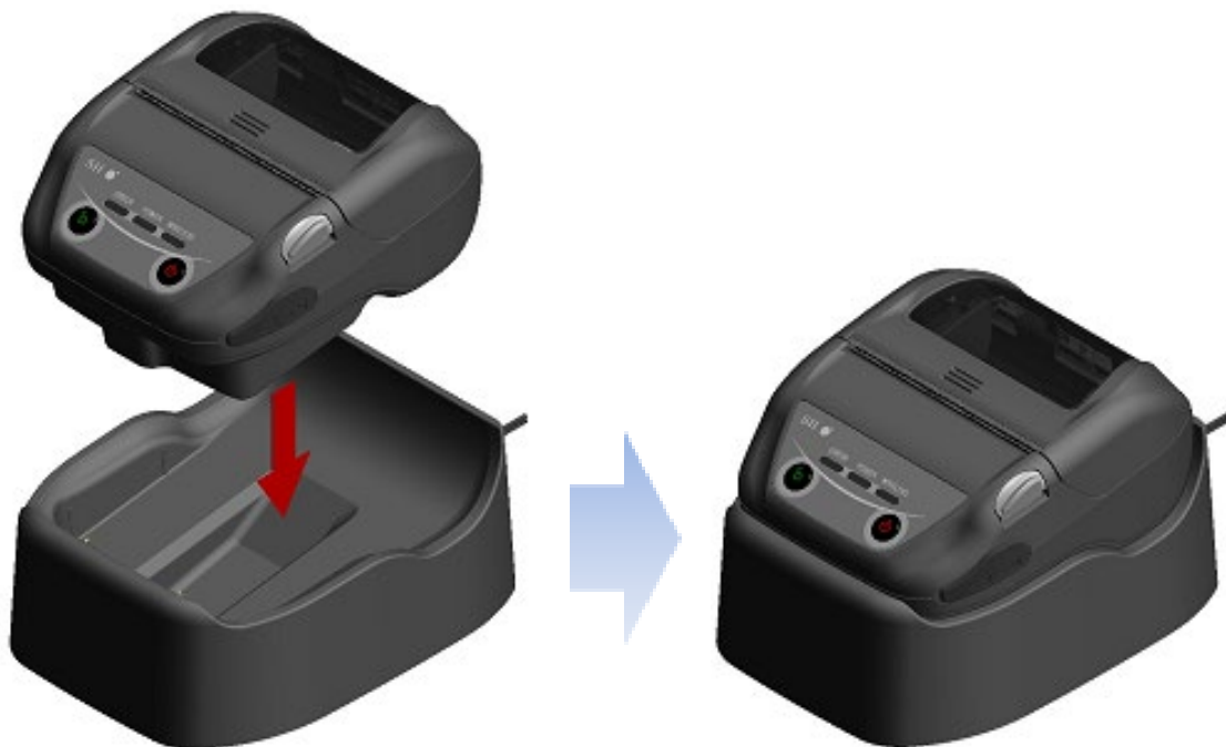
Abbildung 17-3 Drucker und Docking-Station-Verbindung
