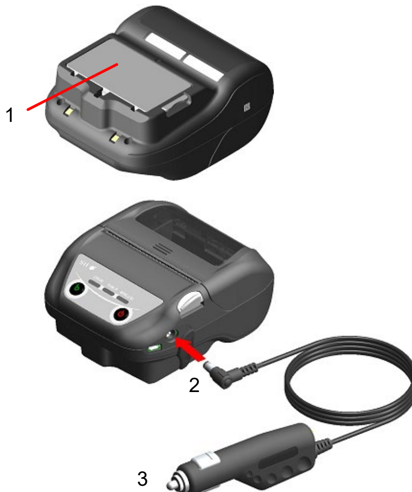
Abbildung 18-3 Aufladen im ausgeschalteten Lademodus mit dem Kfz-Ladegerät
