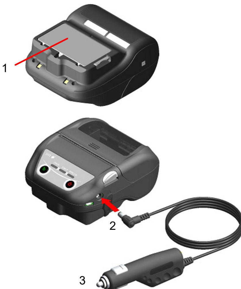
Illustration 18-3 Chargement en mode de chargement hors tension avec le chargeur de voiture
