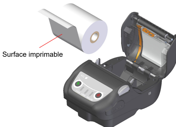
Illustration 9-2 Orientation du papier thermique
