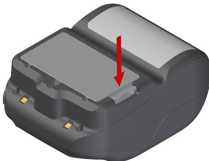
Illustration 8-4 Installation de la batterie (2)
