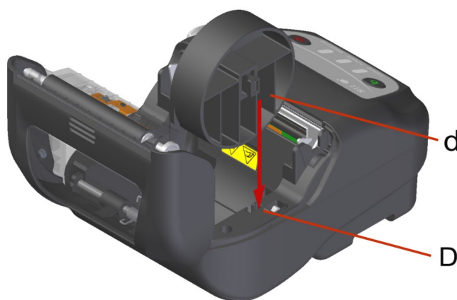
Illustration 14-1 Montage de la plaque de séparation
