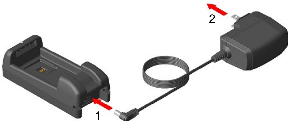
Illustration 19-2 Connexion du chargeur de batterie et de l'adaptateur c.a.
