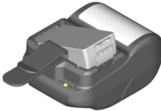
Illustration 15-3 Montage du clip de ceinture (3)
