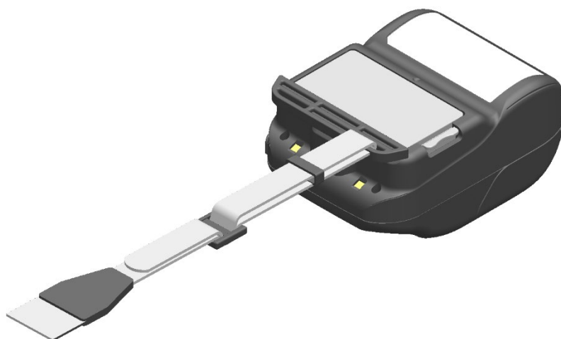
Illustration 15-8 Montage de la bandoulière (4)
