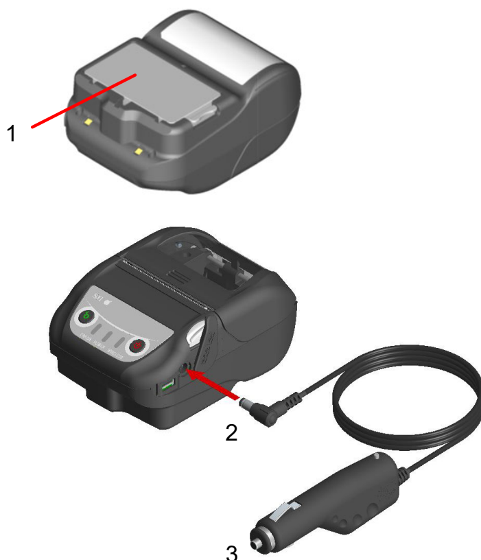
Illustration 18-3 Chargement en mode de chargement hors tension avec le chargeur de voiture
