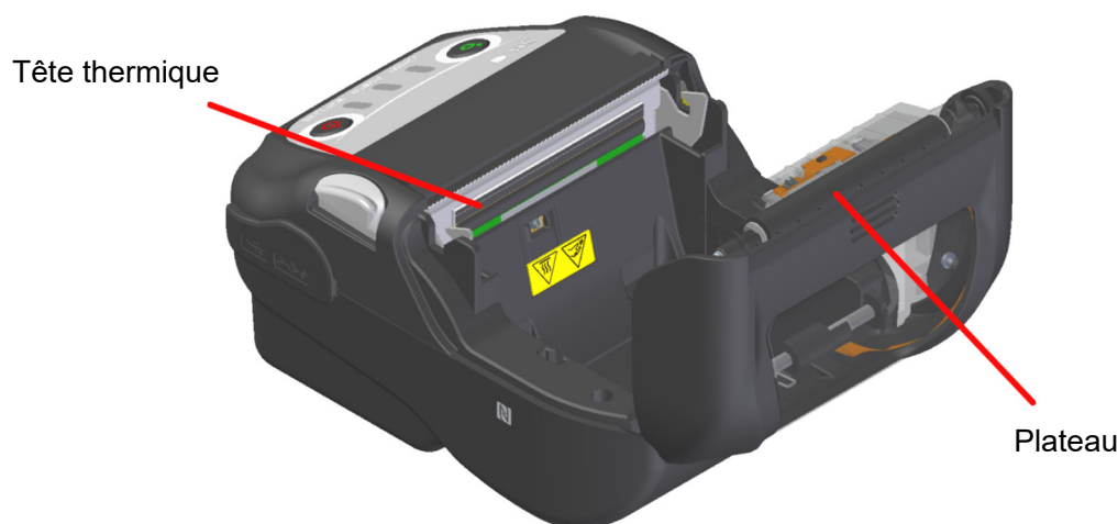
Illustration 20-1 Nettoyage de la tête thermique / du plateau
