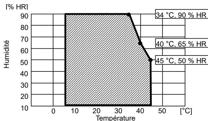
Illustration 16-1 Température de fonctionnement et gamme d'humidité
