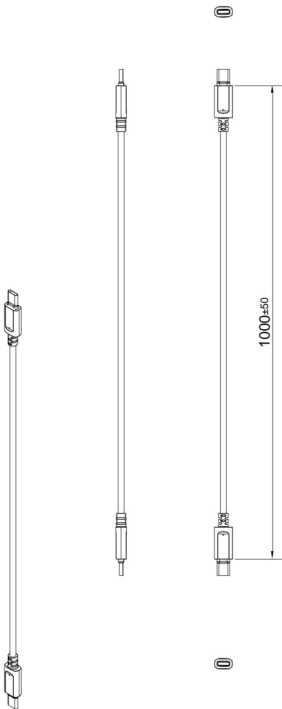
**Art. 304.1054 Anschlusskabel H05VV-F 3G0,75mm<sup>2</sup> L:1,0m sw CEE7/7 / IEC C5**
