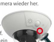
Die LED blinkt jetzt ein Mal und wiederholt dieses Blinksignal nach einer Pause von einer Sekunde (die Anzahl der Blinksignale entspricht der aktuell auswählbaren Boot-Option). Halten Sie den Magneten erneut kurz (< 1 s) an die gekennzeichnete Stelle, um zur nächsten Boot-Option zu wechseln. Nach der letzten Boot-Option wird wieder die erste angezeigt (1 x blinken).
