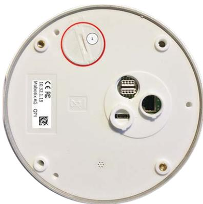
3. **Entriegeln Sie den microSD-Kartenhalter:** Klappen Sie die Metallabdeckung ② der microSD-Karte vorsichtig nach oben (z. B. mit dem Fingernagel).
