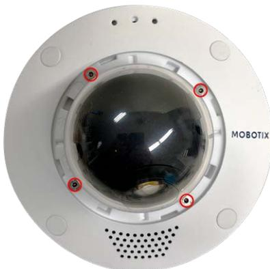
3. Lösen Sie die beiden Innensechskantschrauben ① mit dem Inbusschlüssel [Montagezubehör: Lieferumfang, p. 19](#) auf beiden Seiten der Objektivfassung leicht.
