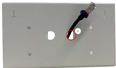
**Abb. 14: Netzwerkverkabelung vorbereiten**
