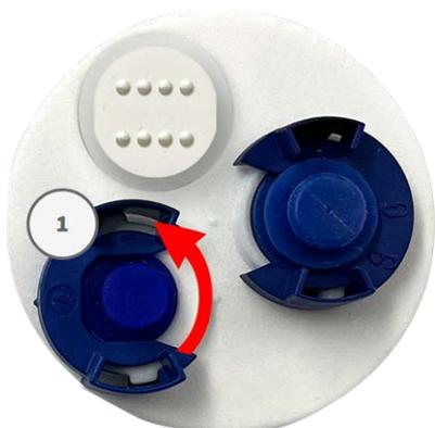
2. Stecken Sie den USB-C-Stecker in den Anschluss und drücken Sie ihn fest hinein, bis der blaue Dichtring einrastet.
