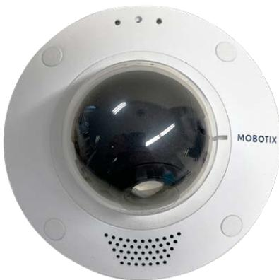
2. Lösen Sie die vier Befestigungsschrauben vom Klemmring mit dem mitgelieferten Inbusschlüssel [Montagezubehör: Lieferumfang, p. 19](#) und ziehen Sie dann vorsichtig die Kuppel ab.
