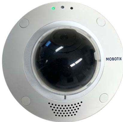
Abb. 17: Kamera-LED am Kameragehäuse
