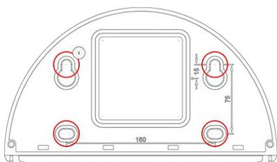
**Abb. 7: Wall Mount mit Bohrungen zur Positionierung der Befestigungsschrauben**
