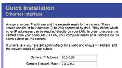
Abb. 21: Netzwerkeinstellungen in der Weboberfläche der Kamera
