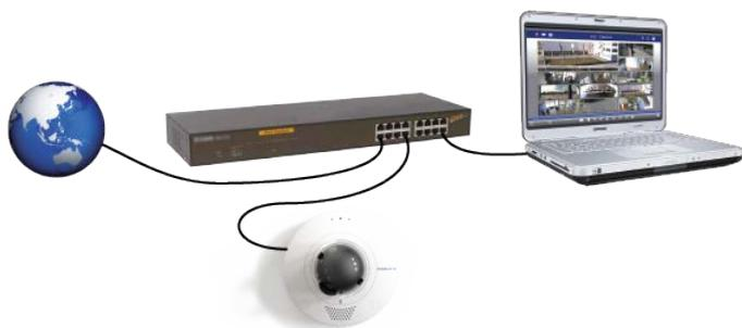
Abb. 16: Stromversorgung über PoE-Switch gemäß PoE Plus (802.3at-2009).
