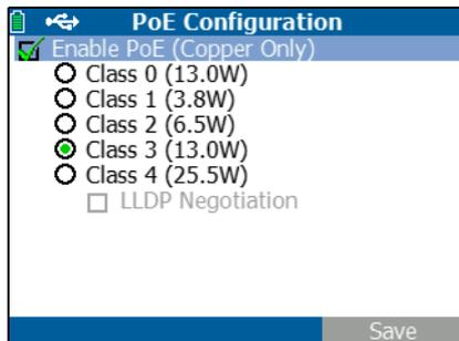
Abbildung 19. PoE-Konfiguration auf Modell LR-AT 1000
