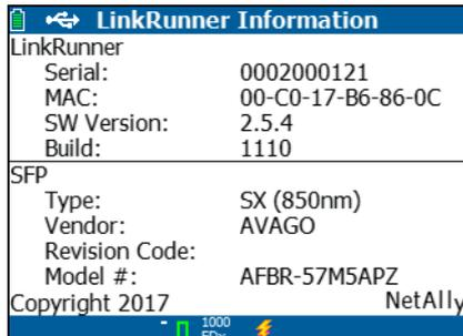
Abbildung 13. LinkRunner-Informationsbildschirm mit angeschlossenem Glasfaseradapter
